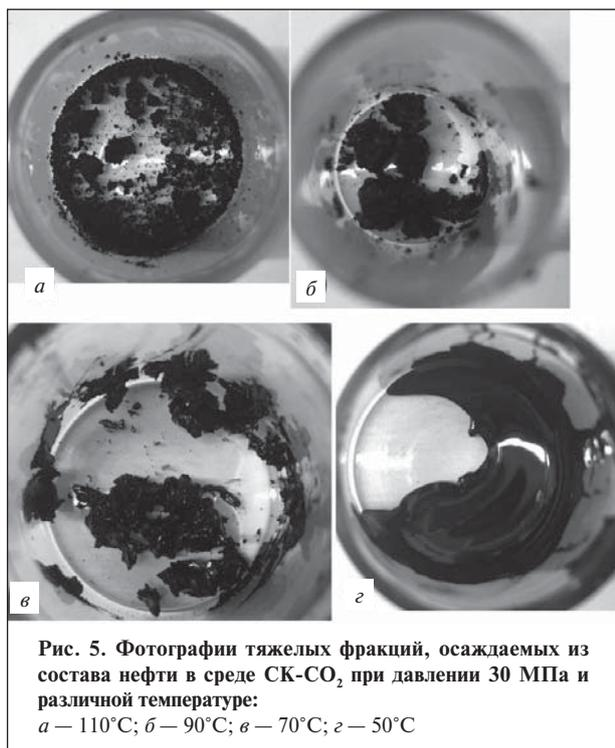
Рис. 5. Фотографии тяжелых фракций, осаждаемых из состава нефти в среде СК-СО<sub>2</sub> при давлении 30 МПа и различной температуре: а — 110°С; б — 90°С; в — 70°С; з — 50°С
