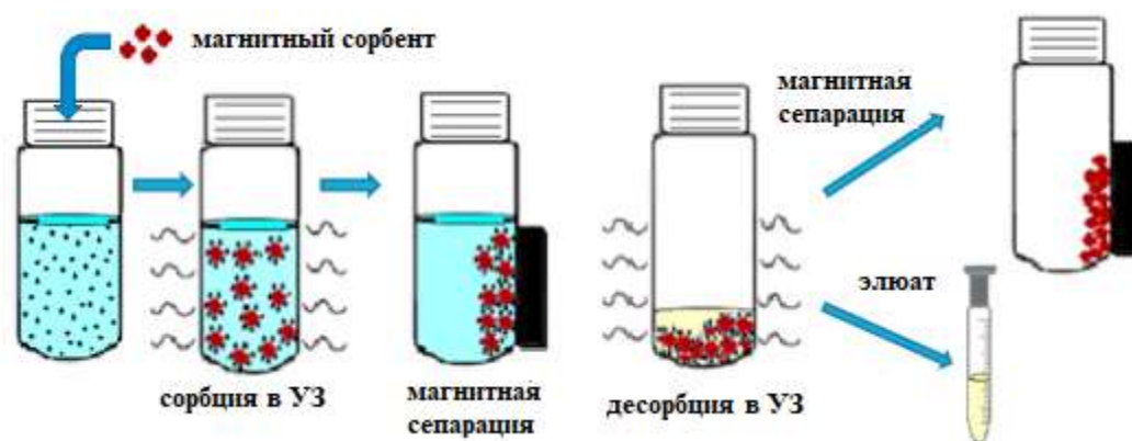
Рисунок 1.4. Схема магнитной твердофазной экстракции в ультразвуковом поле
