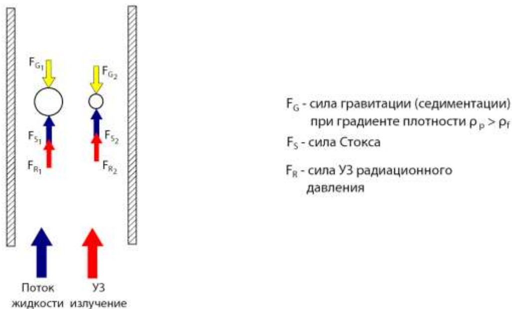
Рисунок 3.1. Схематическое изображение действующих сил радиационного давления и Стокса на частицы сорбента разного размера в потоке жидкости при наложенном ультразвуковом поле
