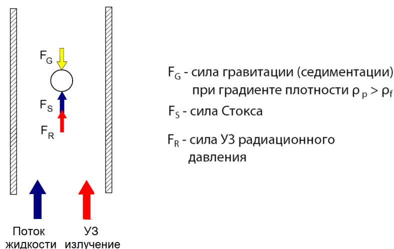
Рисунок 3. Схематическое изображение действия сил радиационного давления ( F_R ), Стокса ( F_S ) и сила гравитации ( F_G ) на частицы, отличающиеся по размерам, в комбинированном поле ультразвуковой стоячей волны и потока жидкости
