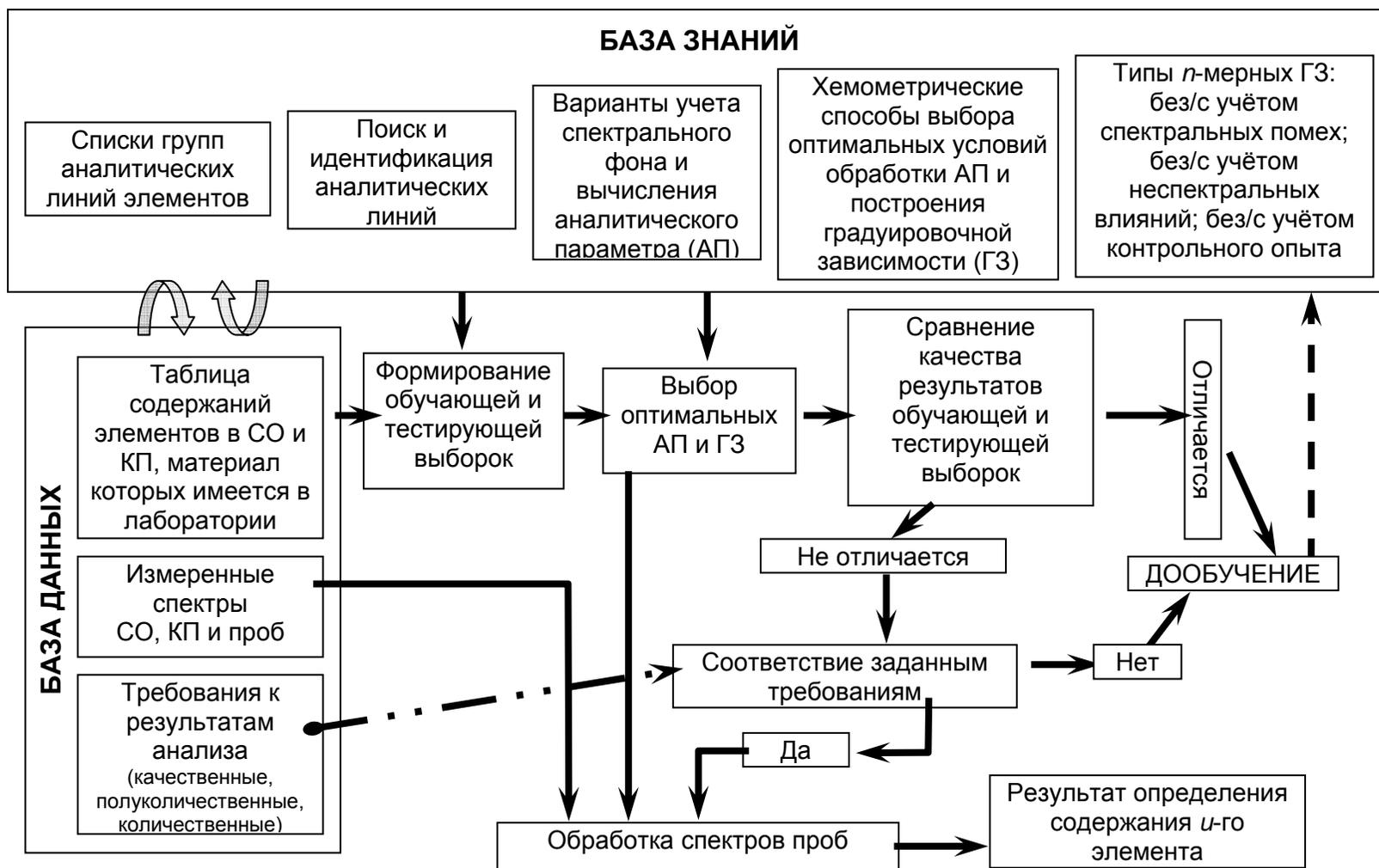
Рис. 2.1. Вербальная модель системы компьютерной интерпретации дуговых атомно-эмиссионных спектров [98].
