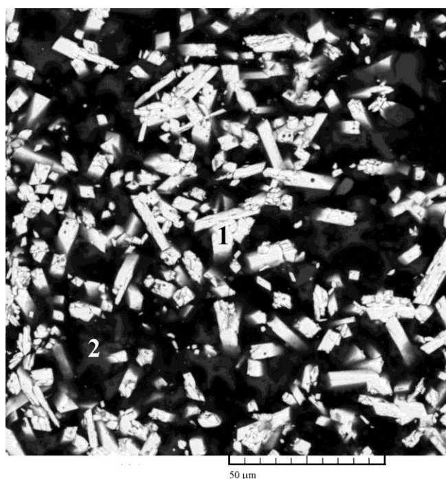
Рисунок 67. Результат опыта 5681 (светлые идиоморфные зёрна (1) – торит, серые неидиоморфные зёрна (2) – стисиито- или торнаситоподобная фаза). Изображение в обратно-рассеянных электронах.
