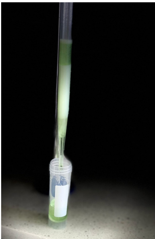
Рис. Хроматографическое выделение изотопов кобальта из раствора облучённого никеля.
