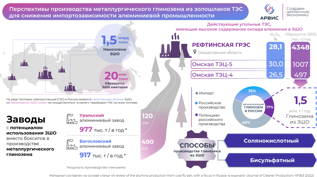
Рисунок. Концептуально-логическое описание потенциала использования золошлаков ТЭС для производства металлургического глинозема
