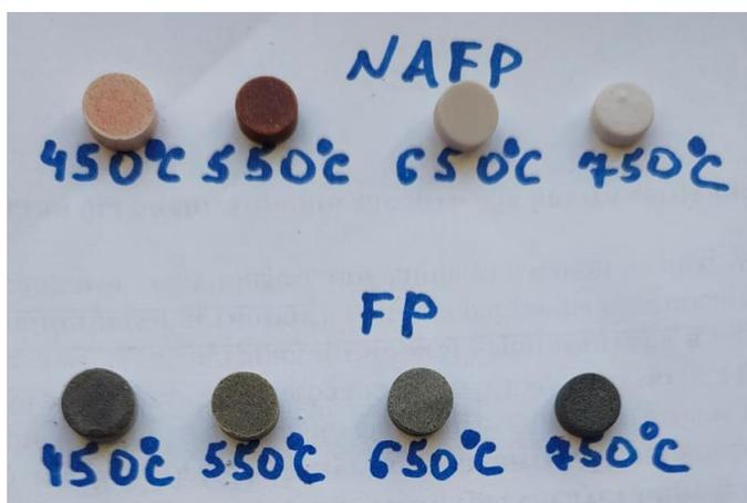
**Рис.** Образцы натрий-алюмо-железофосфатной (NAFP) и железофосфатной (FP) стеклокерамики, полученные при различных температурах.
