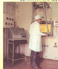
«Горячие» камеры, оснащенные манипуляторами, позволяли работать с высокоактивными образцами (до 100 Ки)
